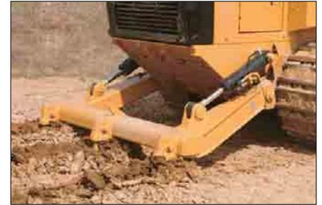
**Ripper scarificatore.** Per la 953D è disponibile un ripper scarificatore radiale montato con due perni inseriti a pressione ai due lati del telaio. Due cilindri assicurano il suo movimento. La trave del ripper ha tre sedi per i denti; i sei perni d'articolazione non richiedono lubrificazione. Il ripper scarificatore della 953D è consigliato per il rippaggio di terreno gelato, asfalto e materiali rocciosi di facile lavorazione. Non è adatto al rippaggio di materiali rocciosi impegnativi.
