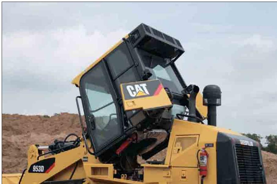
**Cabina inclinabile.** LA 953D è equipaggiata con cabina inclinabile; questa caratteristica facilita gli interventi di manutenzione e riparazione. Inclinando la cabina, si ha un facile accesso ai componenti della trasmissione e del sistema idraulico.
