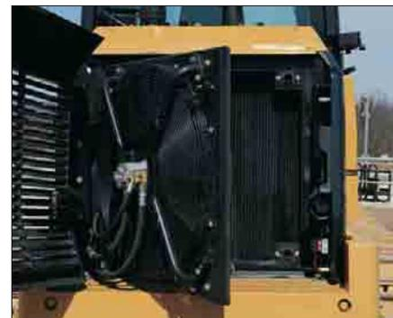
**Sistema di raffreddamento.** La ventola e la griglia di protezione sono incernierate per consentire un agevole accesso, per la pulizia e manutenzione. La griglia per impieghi gravosi, con chiusura a chiave, minimizza l'accumulo dei rifiuti.
