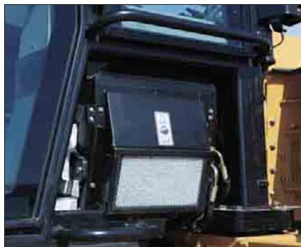
**Filtri aria cabina.** Il filtro aria della cabina, le prese di pressione raggruppate, la barra di blocco della cabina inclinabile, il cilindro idraulico d'inclinazione (optional) e la cassetta attrezzi sono sotto il lato sinistro della cabina.
