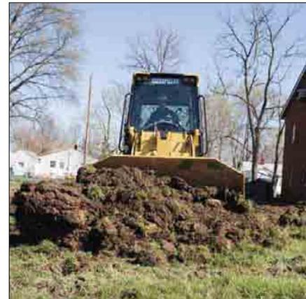
La trasmissione idrostatica, a controllo elettronico, abbina la velocità di marcia con il carico del sistema idraulico, scegliendo automaticamente la velocità più alta fino alla massima selezionata dall'operatore.
