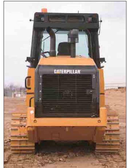
**Posizione motore posteriore.** Il motore, montato posteriormente, assicura un'eccezionale visibilità anteriore ed agisce come contrappeso naturale per bilanciare la stabilità della macchina. permette inoltre di effettuare le operazioni di manutenzione con benna a terra, riducendo nel contempo la possibilità di intasamento e la manutenzione del radiatore.
