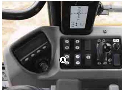
**Impianto di avviamento.** L'interruttore di selezione elettronico della velocità (A), del tipo a culla, posto sulla console di destra, regola il numero di giri motore. Il modulo del sistema elettronico ADEM A4 regola al minimo i giri, all'avviamento del motore. Il numero dei giri motore viene visualizzato sul display digitale della strumentazione, nel menù "prestazioni" del Messenger.
