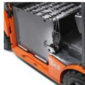
Estrazione laterale della batteria con rulliera
